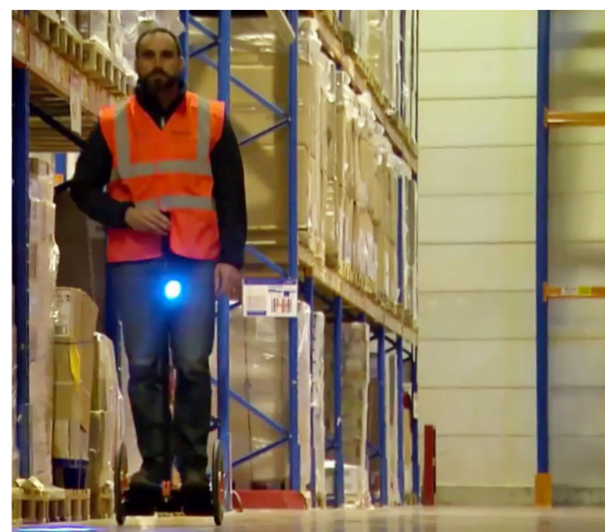
Gyropode mis en service par la société FM-Logistic. À noter: le recours à un spot projetant une marque au sol pour assurer la visibilité du travailleur, y compris aux intersections (Image extraite du film "Le gyropode au service des plateformes de logistique" réalisé par la société Hublex).
