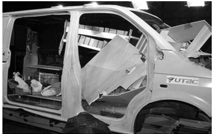
Ce cliché d'un crash-test réalisé par l'UTAC pour le compte de la société Sortimo démontre le danger que représente un chargement mal arrimé pour les conducteurs de véhicules utilitaires légers.
